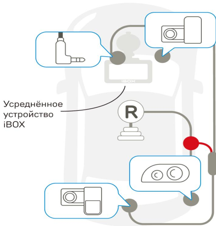
Проложите шнур камеры в салоне автомобиля и подключите его в разъём на устройстве или креплении устройства (в зависимости от модели устройства торговой марки iBOX). Красный провод шнура соедините с проводом в автомобиле, на котором появляется напряжение +12 В при включении передачи заднего хода (например, к фонарю заднего хода автомобиля).
